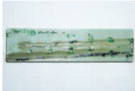
Abb. 6 Klotz nach schädlichen Wechselwirkungen
